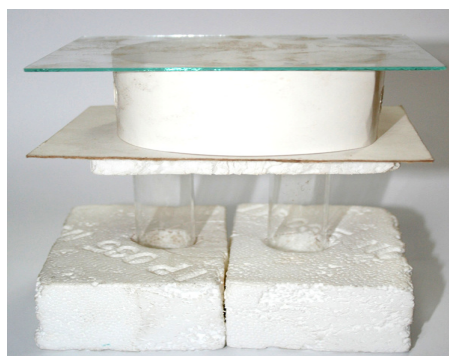
Fig. 5: Olfatómetro de caída de “cartoncillo” de 2 pozos ( \varnothing de cámara = 10 cm.)
