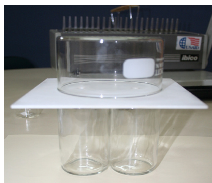
Fig. 7: Olfatómetro de vidrio para utilizarlo con capilares ( \varnothing de cámara = 10 cm.)
