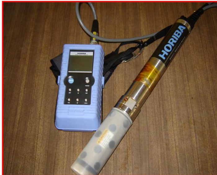
Anexo 4. Monitor de calidad de agua marca HORIBA, equipo utilizado para toma de parámetros físico-químico.
