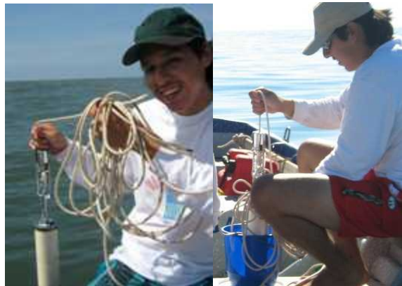
Fig. 10: Colecta de muestras utilizando una botella muestreadora tipo Van Dorn
