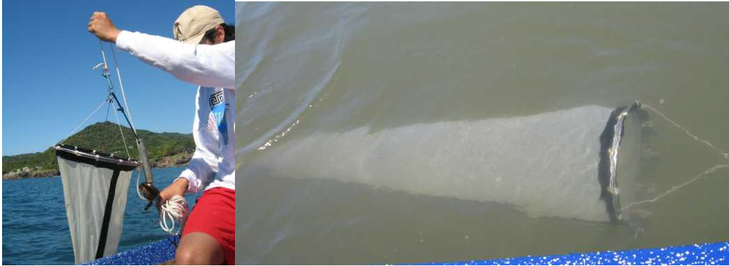
Fig. 9: Uso de la red de fitoplancton para coleccionar muestras cualitativas.
