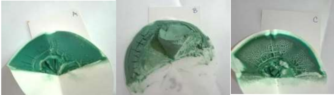
Figura 4.11. Lodos generados con 1.8g de coagulante en el tercer ensayo de coagulación óptima.
