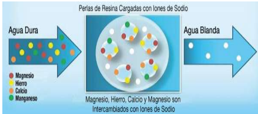
Figura 3.9. Principio de purificación de agua con resinas de intercambio iónico. Fuente: Aguapura Fadecen, 2012.
