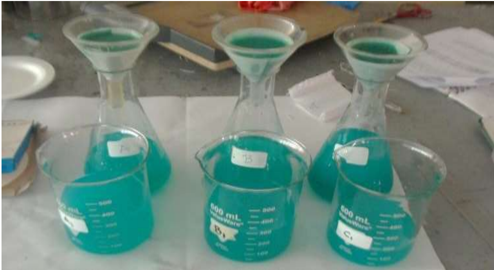
Figura 4.10. Etapa de filtración para determinar lodos retenidos. Fuente: elaboración propia, 2016.
