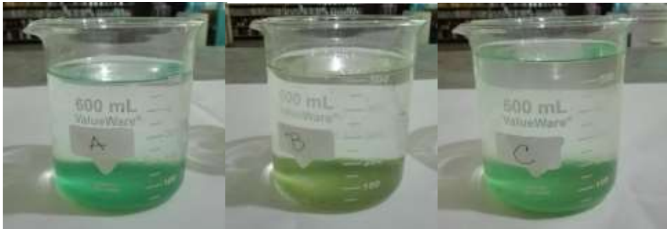
Figura. 4.9. Muestras de agua residual sedimentada con 70 gramos de solución de hipoclorito de calcio al 1% P/P. Fuente: elaboración propia, 2016.
