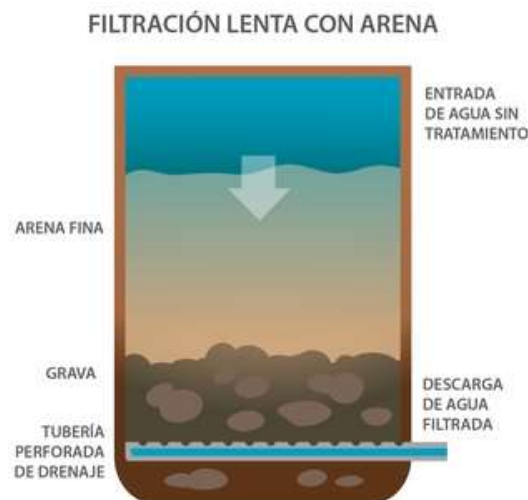
Figura 3.2. Proceso primario de filtración con capa de arena. Fuente: Academia Nacional de Ciencias, 2007.
