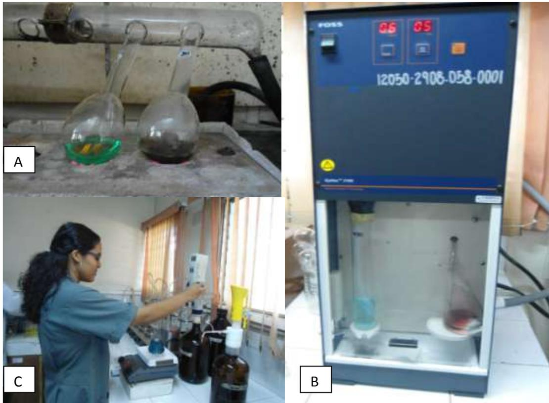
Figura 5: Método de Micro Kjeldhal para la determinación del Nitrógeno Total. (A) Digestión ácida; (B) Destilación; (C) Titulación.
