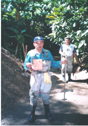
Fotos No. 1 y 2 Equipo de hidrometria utilizado para la medición de caudal en la corriente
