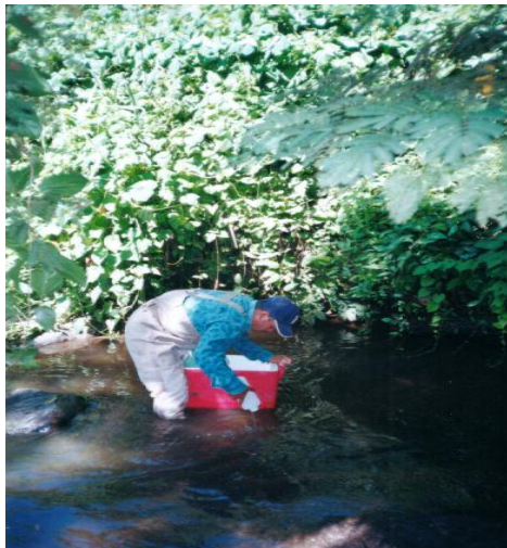
Foto 4 Procedimiento de toma la muestra de agua y enjuague del frasco
