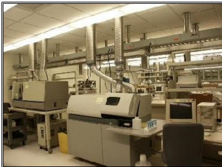
Figura 63. Imagen del sistema acoplado de CG/EM (IUBO “Antonio González”)
