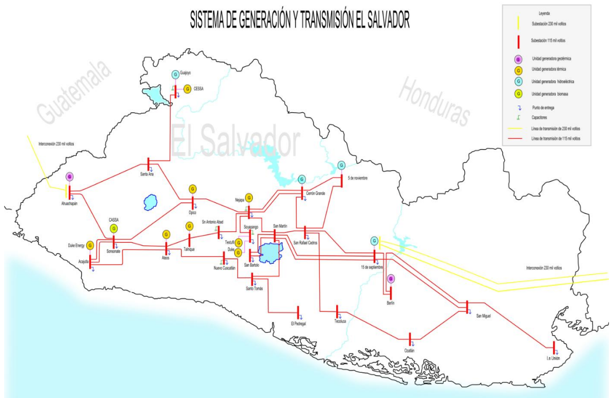
Figura 1.1 Diagrama unifilar de El Salvador.
