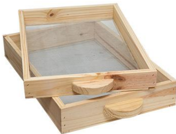
Figura 8: Zarandas manuales para limpieza por tamaño (tomada de Google).
