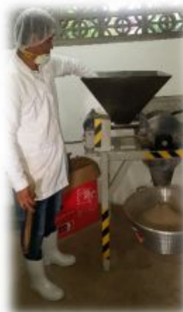
Anexo 21. Pulverizando la mezcla pre-molida.
