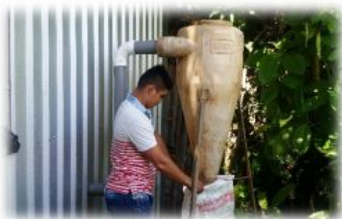
Anexo 26. Prueba de un ciclón adaptado en la trilladora de café.
