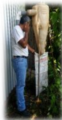
Anexo 27. Prueba de un ciclón adaptado en la trilladora de café.
