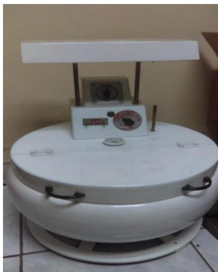
Una centrifuga es una máquina que mantiene en rotación una muestra para –por fuerza centrífuga– acelerar la decantación o la sedimentación de sus componentes o fases (generalmente una sólida y una líquida), según su densidad.
