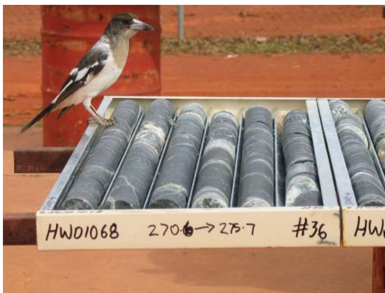
Figura 10. Muestras de núcleos durante la perforación de exploración (Creative Commons)
