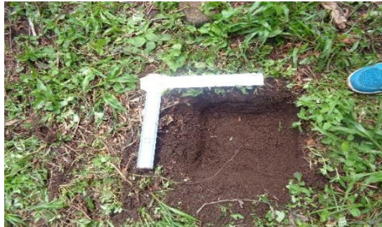
Figura 6. Delimitación y excavación para muestreo de macroinvertebrados edáficos.
