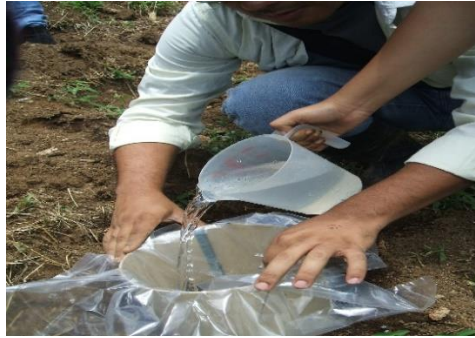
Figura 4. Preparación de la prueba de infiltración.
