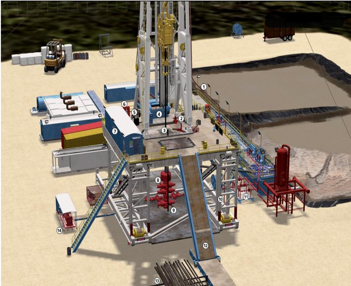
Fig. 13 Componentes principales de un equipo de perforación (J. Pérez Graphics & Design)
