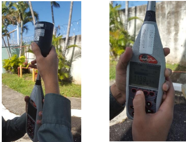
Fotografía 1: calibración de sonómetro en campo.
