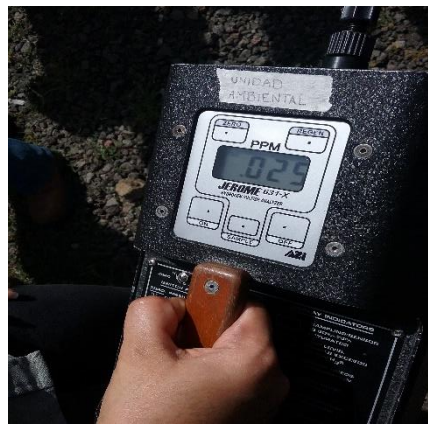
Fotografía 2: Equipo de medición de Sulfuro Hidrogeno Jerome 631 [Diplomado, 2016].
