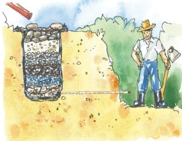
Figura 1. Construcción de un filtro de aguas grises.
