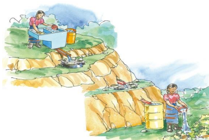
Figura 2. Construcción de un filtro de aguas grises.
