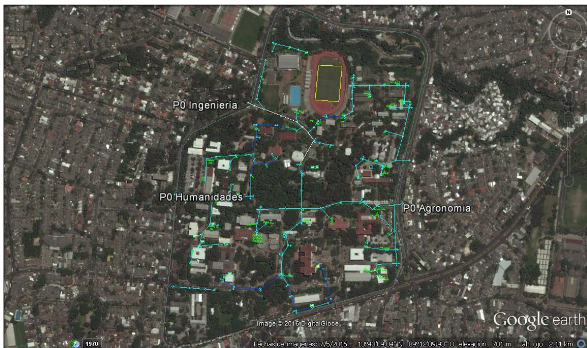
Figura 21. Diagrama unifilar UES.
