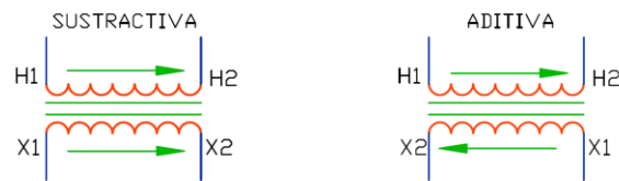
Figura 7. Polaridad de transformadores.
