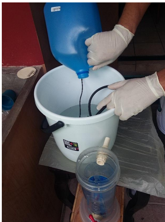
Figura 3.21. Alimentación de solución de fluoruros a sistema experimental.
