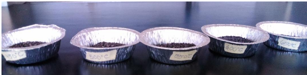
Figura 2. Muestras tamizadas de hueso en sus respectivas temperaturas de calcinación
