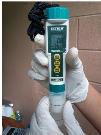
Figura 3.24. Medición de fluoruros en agua tratada con recirculación.
