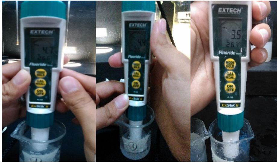
Figura 3.5. Medición de fluoruros a muestras de hueso molido sin calcinar posterior a prueba de jarras.
