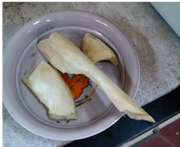
Figura 5. Hueso desgrasado listo para calcinar
