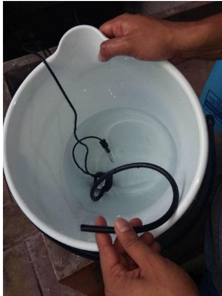
Figura 3.32. Recipiente de alimentación de sistema de tratamiento óptimo con bomba de 5 watts.
