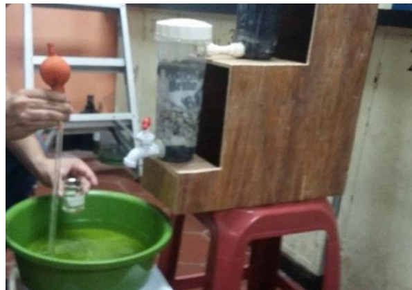
Figura 3.13. Toma de muestra a la salida del tratamiento preliminar.
