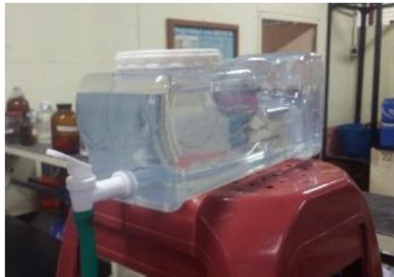
Figura 3.11. Recipiente de alimentación de sistema de tratamiento preliminar.
