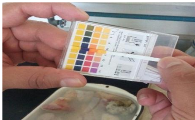
Figura 10. Primera verificación de neutralización con papel pH.
