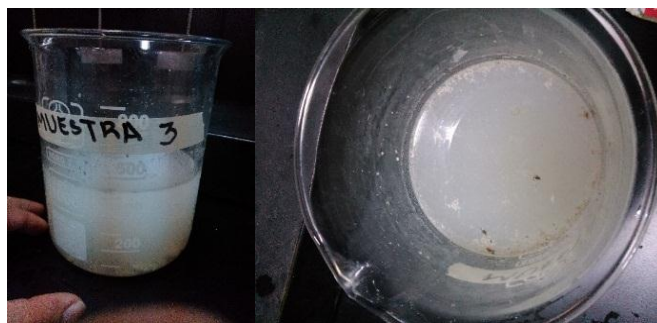
Figura 3.6. Muestra de agua de pozo tratada con hueso molido sin calcinar.
