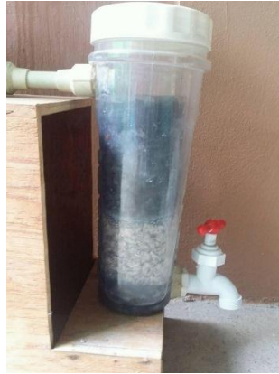
Figura 3.29. Tercera etapa de sistema tratamiento experimental óptimo.
