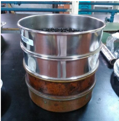
Figura 13. Procedimiento del tamizado entre malla 35 y malla 6
