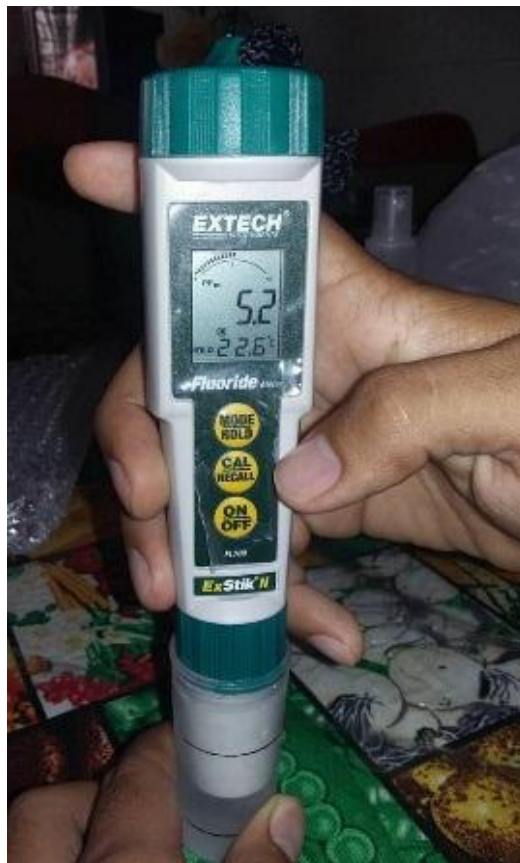
Figura 3.31. Medición de concentración de fluoruros para muestra de agua de pozo, previo a experimento óptimo.
