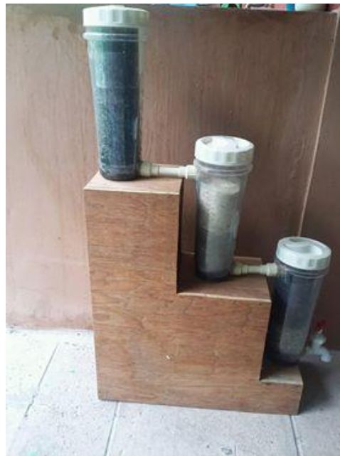
Figura 3.30. Montaje experimental de sistema de tratamiento con las condiciones óptimas.
