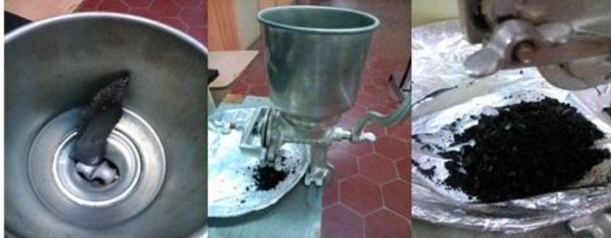
Figura 12. Procedimiento de reducción de tamaño del hueso
