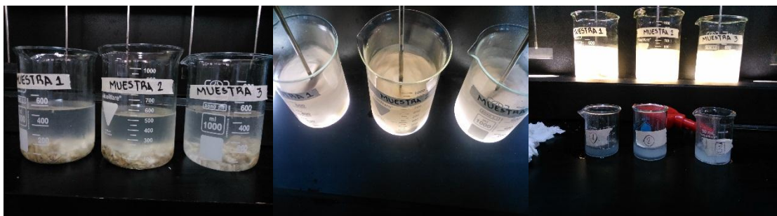
Figura 7. Realización de prueba de jarras a muestras de hueso molido sin calcinar
