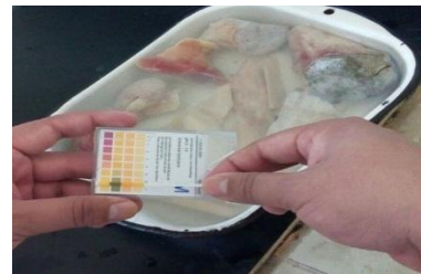
Figura 11. Segunda verificación de neutralización con papel pH.
