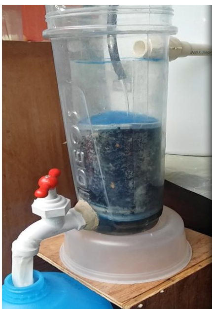
Figura 3.22. Circulación de agua fluorada por columna de 11 cm de hueso calcinado.
