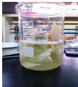
Figura 8. Lavado de hueso con ácido clorhídrico.
