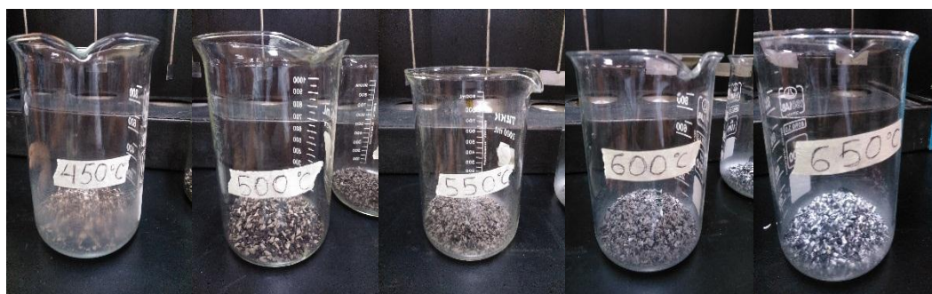
Figura 4. Muestras de 50g de hueso calcinado en beaker para prueba de jarras
