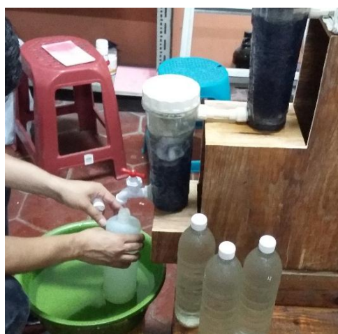
Figura 3.17. Toma de muestras de agua tratada para su posterior análisis de laboratorio.
