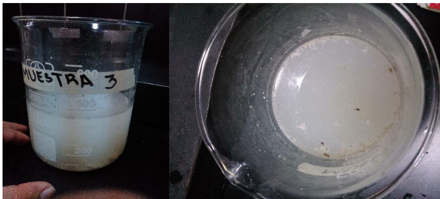
Figura 8. Muestra de agua de pozo tratada con hueso molido sin calcinar.
