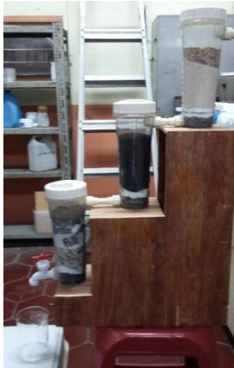
Figura 3.12. Montaje de sistema de tratamiento preliminar
