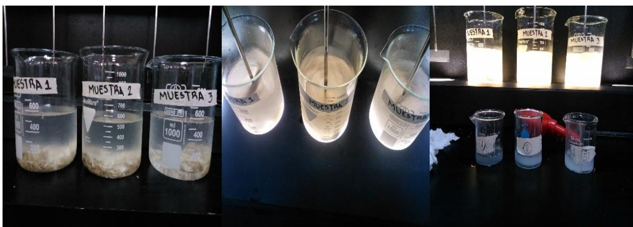
Figura 3.4. Realización de prueba de jarras a muestras de hueso molido sin calcinar
