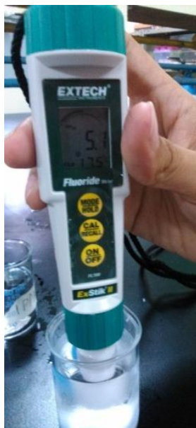
Figura 1. Primera medición de Fluoruros de la muestra de agua de pozo con el medidor de fluoruro ExStik FL700
