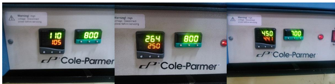
Figura 6. Temperaturas para realizar la calcinación del hueso
