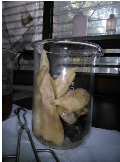
Figura 4. Hueso bovino luego del primer lavado con Hidróxido de Sodio
