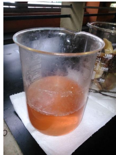
Figura 5. Hidróxido de Sodio con remanentes de grasa
