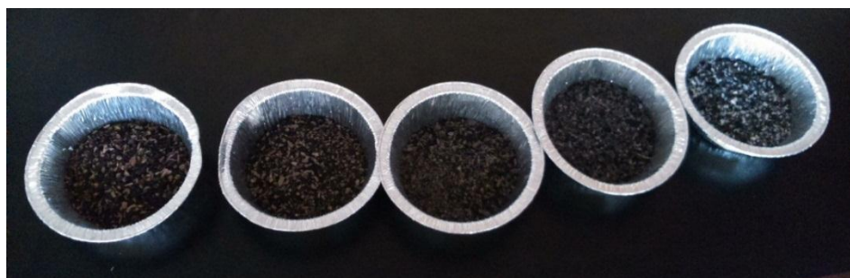
Figura 3. Muestras tamizadas de hueso en sus respectivas temperaturas de calcinación (450°C, 500 °C, 550 °C, 600 °C y 650 °C).
