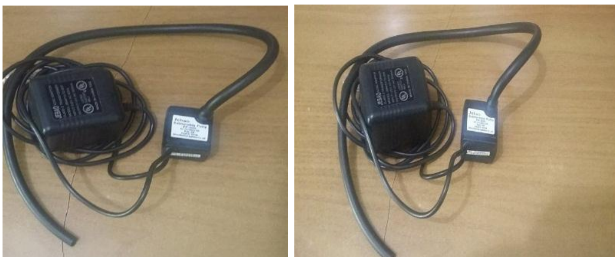
Figura. 3.18. Bomba sumergible de 5 watts, y de 50 cm de cabeza de presión
