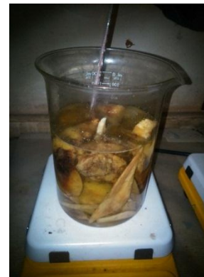
Figura 3. Calentamiento del hueso bovino a 50°C
