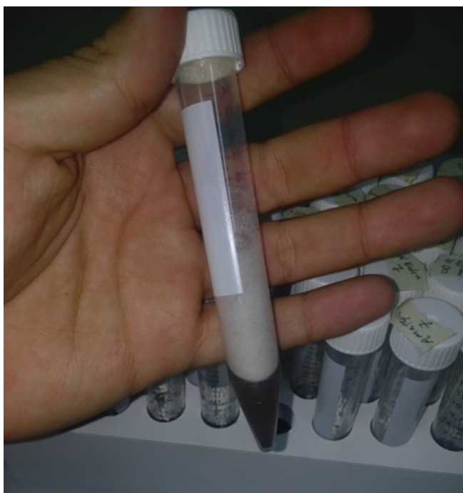
Figura 2.3: Muestra de suelo, antes de ser sometida a baño ultrasónico (homogeneización)
