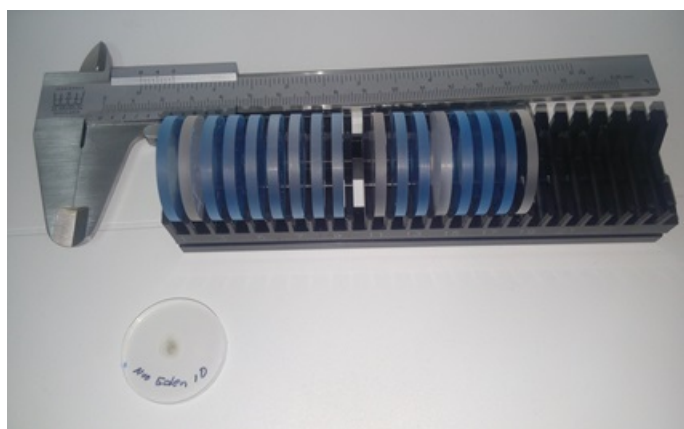
Figura 2.4: Cassete de medición, con capacidad de 25 muestras
