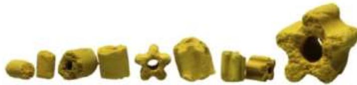
Figura 3.4. Fotografía de piezas de catalizadores. Anillos, anillos de estrella y pellets (King et al, 2013).
