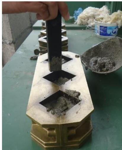
**Figura A-2.2.2:** Elaboración de Cubos de mortero, especímenes fabricados en la obra.
