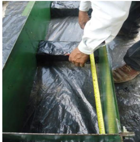
*Figura 3.6: Colocación de piezas de adobe forradas con plástico.*
