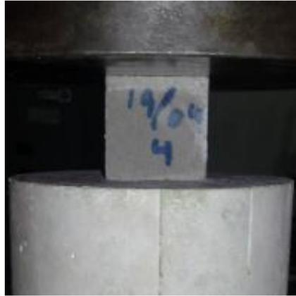
**Figura A-6.2.1:** Resistencia a compresión a 28 días de cubos de mortero, fabricados en el laboratorio.
