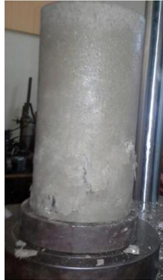
**Figura A-4.1.1:** Resistencia a la compresión del concreto, 7 días.
