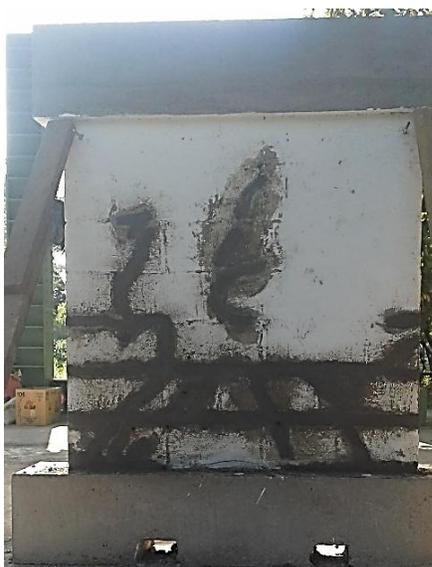
*Figura 5.14: Producto final de la colocación del material de reparación*
