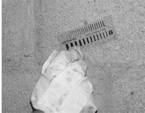
*Figura 2.4: Comparador plástico de grietas o grietómetro.*
