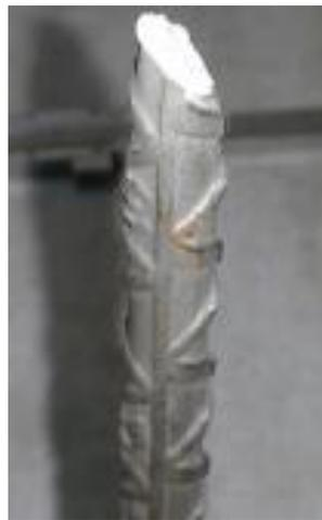
**Figura A-7.1.2:** Fractura en diagonal, varilla N°3.
