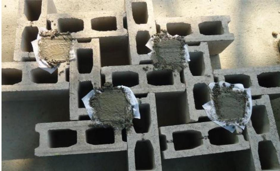
**Figura A-5.1.1:** Elaboración de prismas de Grout.
