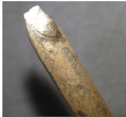
**Figura A-7.1.2:** Fractura cónica, varilla N°2.
