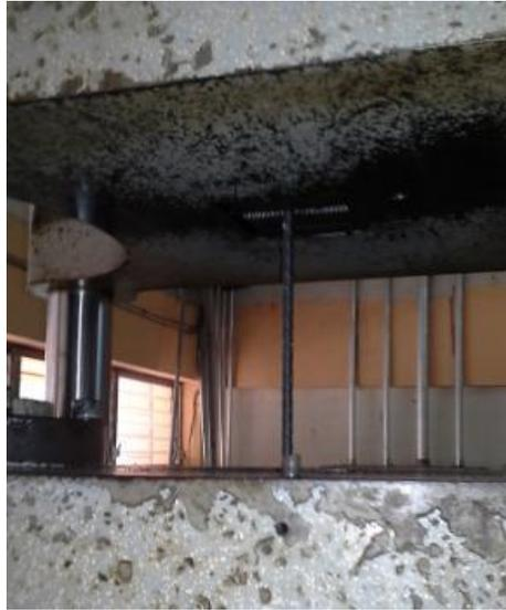
**Figura A-7.1.1:** Resistencia a la tensión, varilla N°3.
