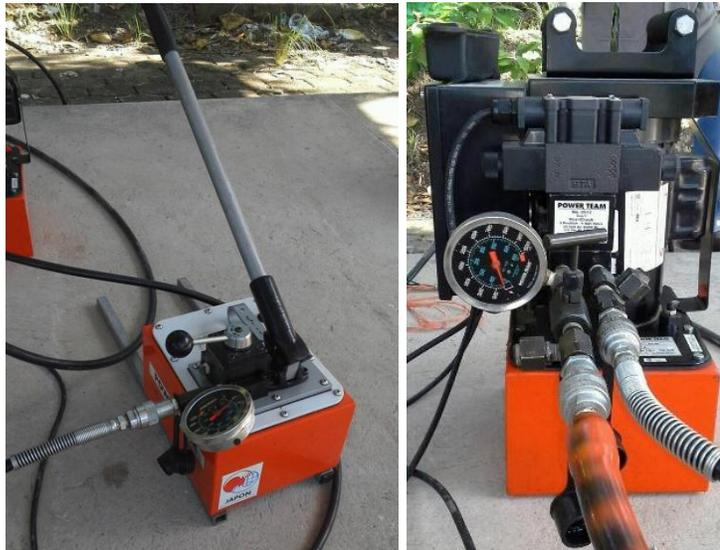
*Figura 3.31: izquierda válvula manual para fuerza vertical, derecha válvula eléctrica para fuerza horizontal.*
