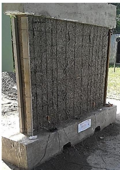
*Figura 5.23: Colocación de cañuelas en los extremos de la pared*
