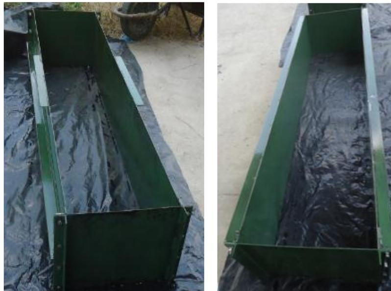
*Figura 3.4: Moldes metálicos para colado de las soleras base.*
