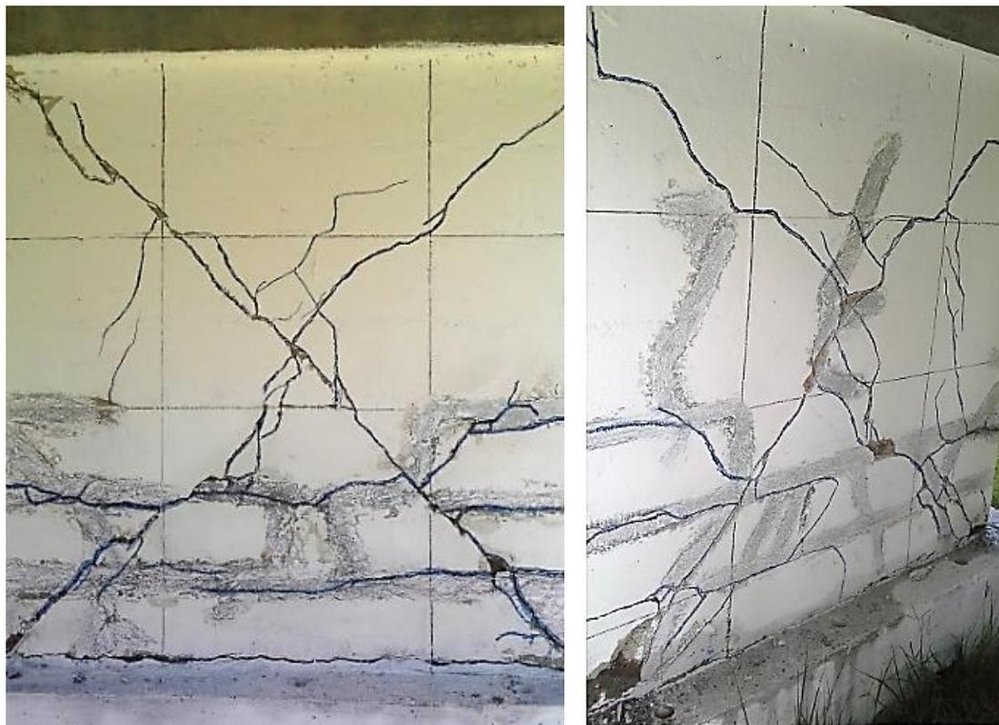
*Figura 5.31: Estado final del daño, pared BC-M03RP [Izquierda: Vista Oeste; Derecha: Vista Este].*
