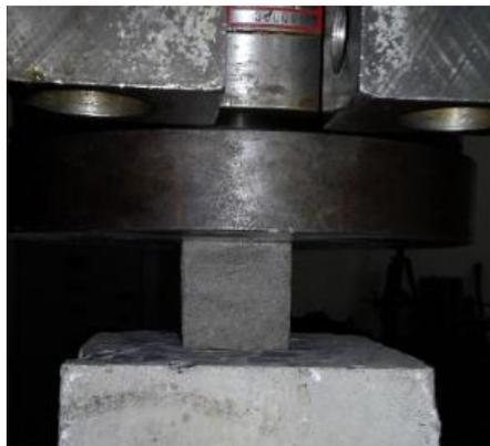
**Figura A-6.2.3:** Resistencia a compresión a 28 días de cubos de mortero, fabricados en la obra.
