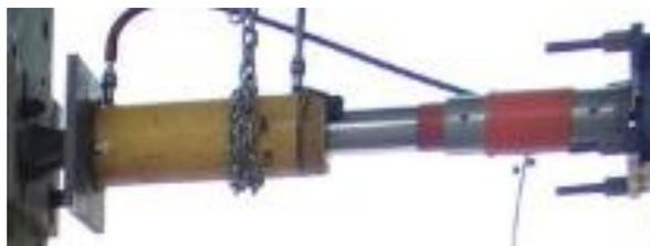
Figura 3.30: Izquierda gato hidráulico 50 ton, derecha celda de carga 50 ton.
