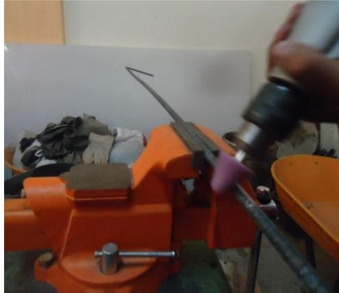
Figura 3.10: Desgaste de superficie con taladro y esmeril.
