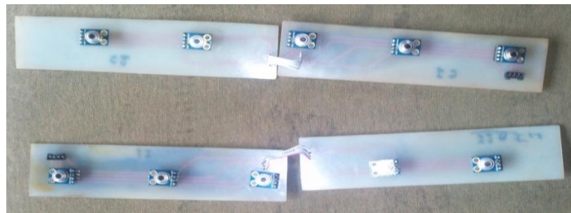
Figura 52. Unión de los sensores MLX90614 a las placas de circuito impreso (Fuente propia).
