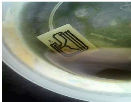
Figura 55. Remojo de las placas de cobre en ácido (Fuente propia).
