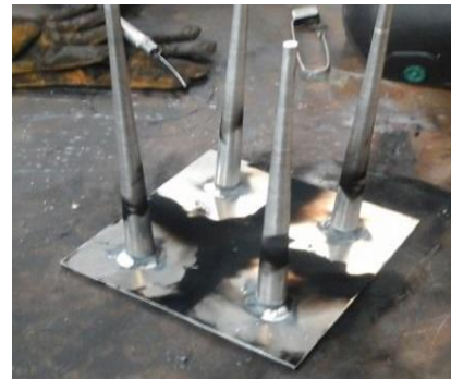
Figura 45. A la izquierda se muestra una aleta individual y al derecha un conjunto de aletas durante el proceso de soldadura (Fuente propia).
