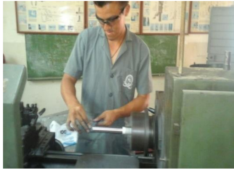
Figura 44. Lijado de piezas cilíndricas y cónicas en el torno (Fuente propia).
