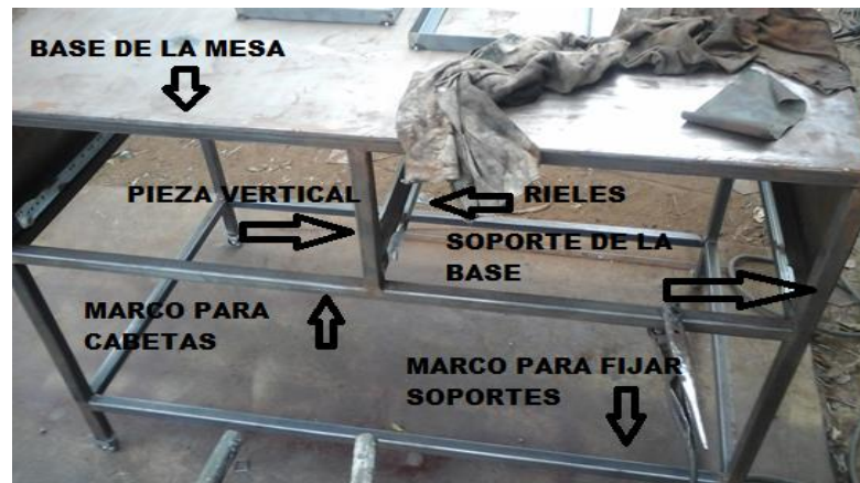
Figura 34. Elaboración de mesa de banco de pruebas (Fuente propia).
