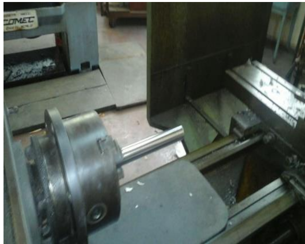
Figura 43. Colocación de trozos de aluminio y acero en el torno (Fuente propia)
