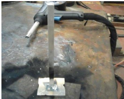
Figura 45. A la izquierda se muestra una aleta individual y al derecha un conjunto de aletas durante el proceso de soldadura (Fuente propia).
