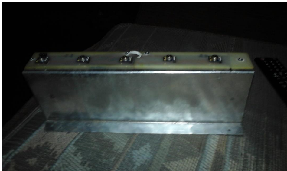
Figura 58. Unión de las placas de los sensores con el riel para aletas de conjunto (Fuente propia).
