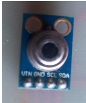
Figura 33. Sensor infrarrojo MLX90614 (Fuente propia).
