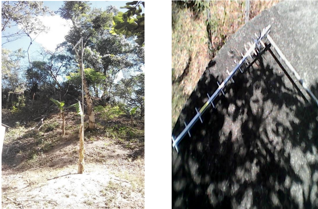
Figura 3.12: Antenas utilizadas para amplificar la señal
