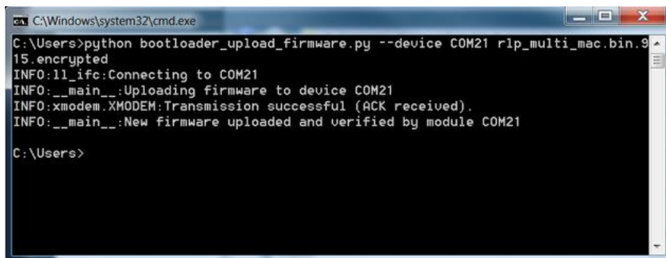
Figura 2.4: Firmware ya instalado en modulo LL-RXR-27
