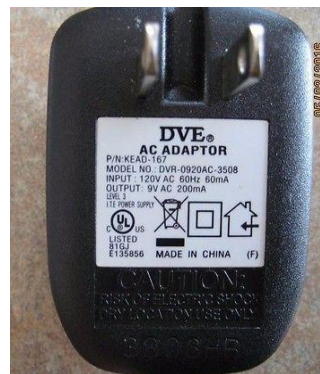
Figura 3.2.1: fuente de voltaje 240V AC/ 9V AC
