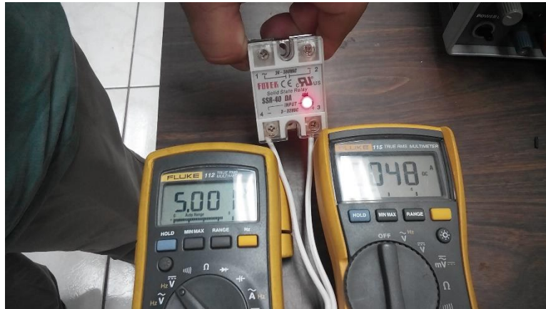
Figura 2.16: Comprobación de corriente RMS para relé de estado sólido
