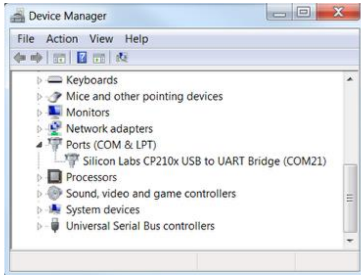
Figura 2.2: comprobación de puerto COM a utilizar en la instalación
