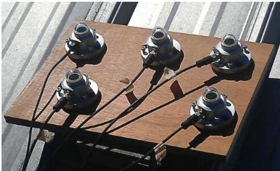
Figura 3.2 Piranómetros en una superficie plana.
