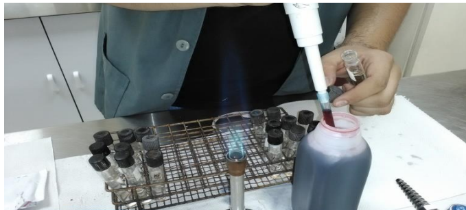
Figura 3.27. Procedimiento de dilución para concentrado y refresco.
