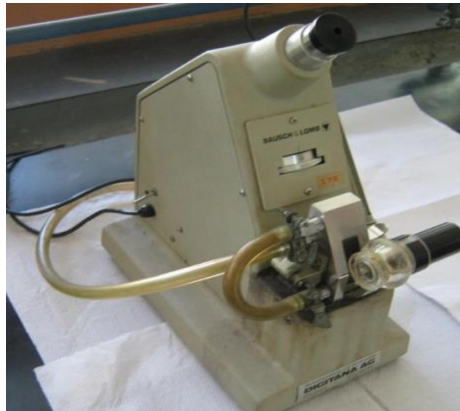
Figura 2.1. Refractómetro de Abbe utilizado para la determinación de °Brix.
