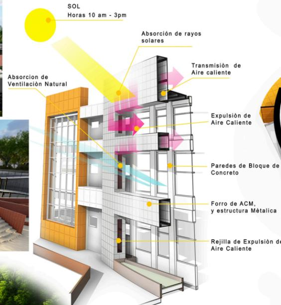
ESQUEMA DE FUNCIONAMIENTO DE EXPULSION DE CALOR EN ENVOLVENTE DEL EDIFICIO
