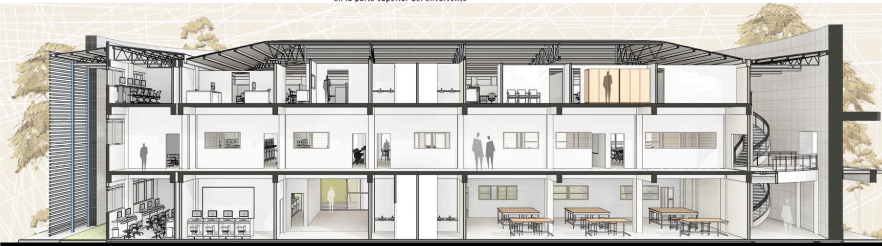
SECCION TRANSVERSAL del Edificio
