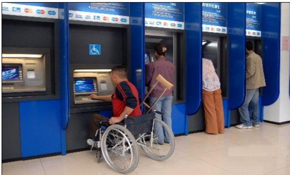
Figura 14. Cajeros automáticos accesibles para personas en sillas de ruedas. Fuente. Retomado de http://www.avanbank.com/files/2014/02/ATM-4-disabled.jpg y consultado el 22 de noviembre de 2016
