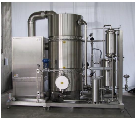
Ilustración 67. Destilador y Condensador
