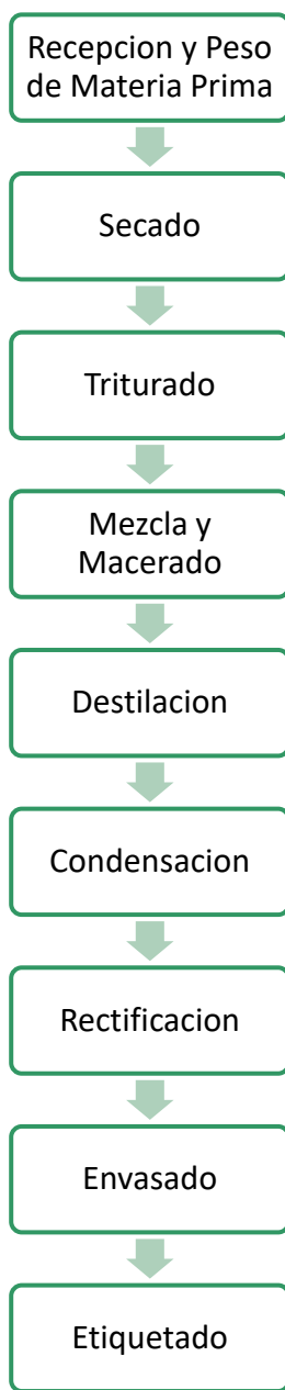
Diagrama 42. Proceso requerido para el Furfural
