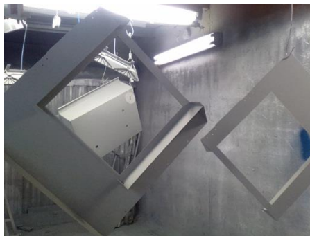
Ilustración 72-Proceso de curado de la pintura
