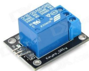
Ilustración 47-Relé para arduino
