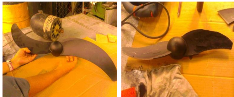
Ilustración 62-Propela antes y después del corte
