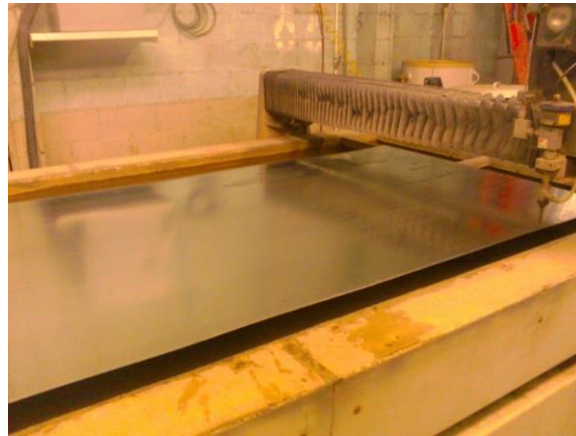
Ilustración 65-Cortadora con agua CNC
