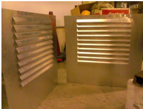
Ilustración 69-Piezas de chapa de recubrimiento con persianas
