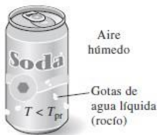
Ilustración 19-Efecto de la condensación del vapor de agua sobre una superficie más fría que el ambiente (Rocío)
