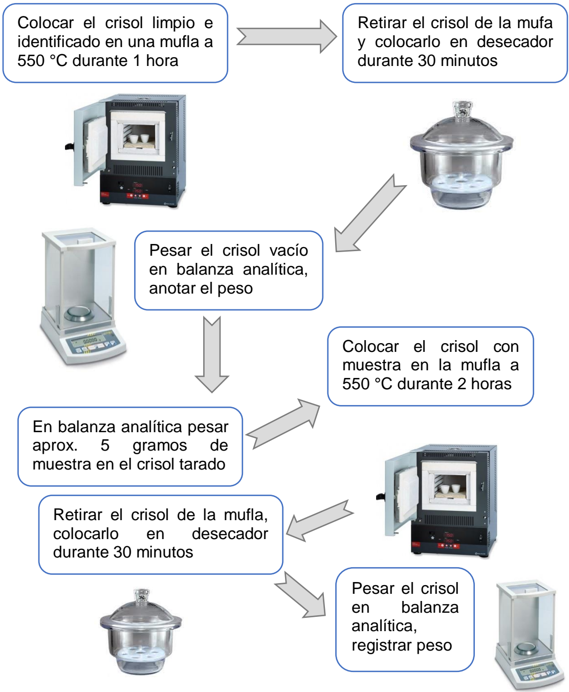
Figura N°20. Esquema determinación de cenizas.
