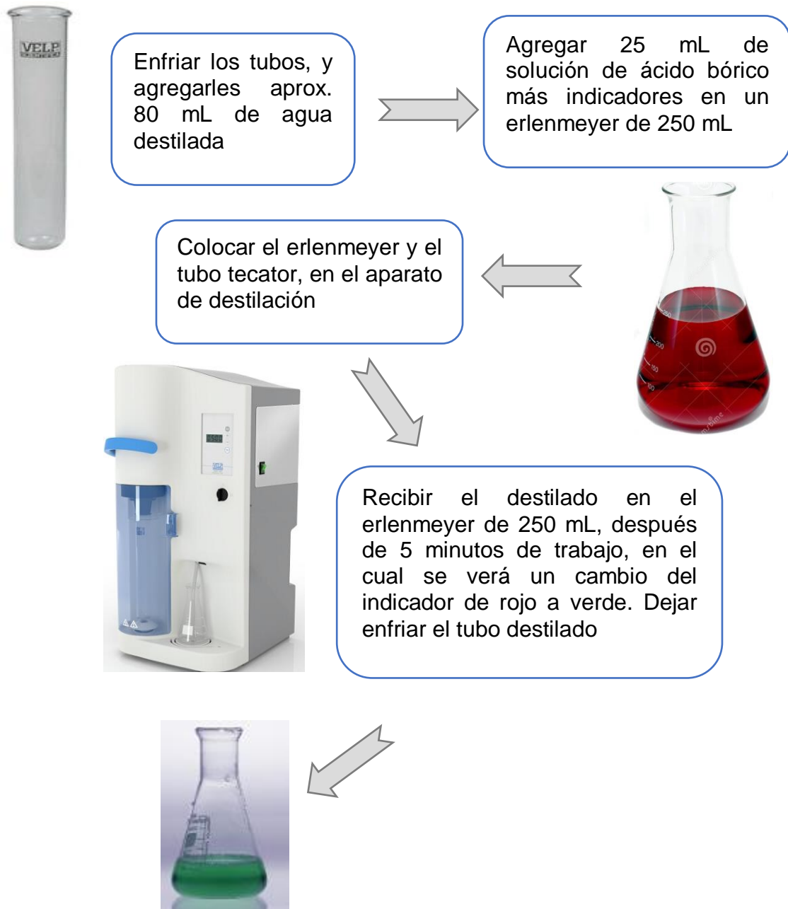
Figura N°22. Procedimiento para la determinación de nitrógeno proteico, etapa de Destilación.
