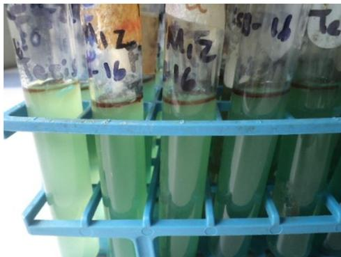
Figura N° 6. Presencia de anillo color rojo en la determinación de *Escherichia coli* en muestras de jugos naturales de naranja y zanahoria utilizando caldo fluorocult (LMX) como sustrato, por el método de Número Más Probable.
