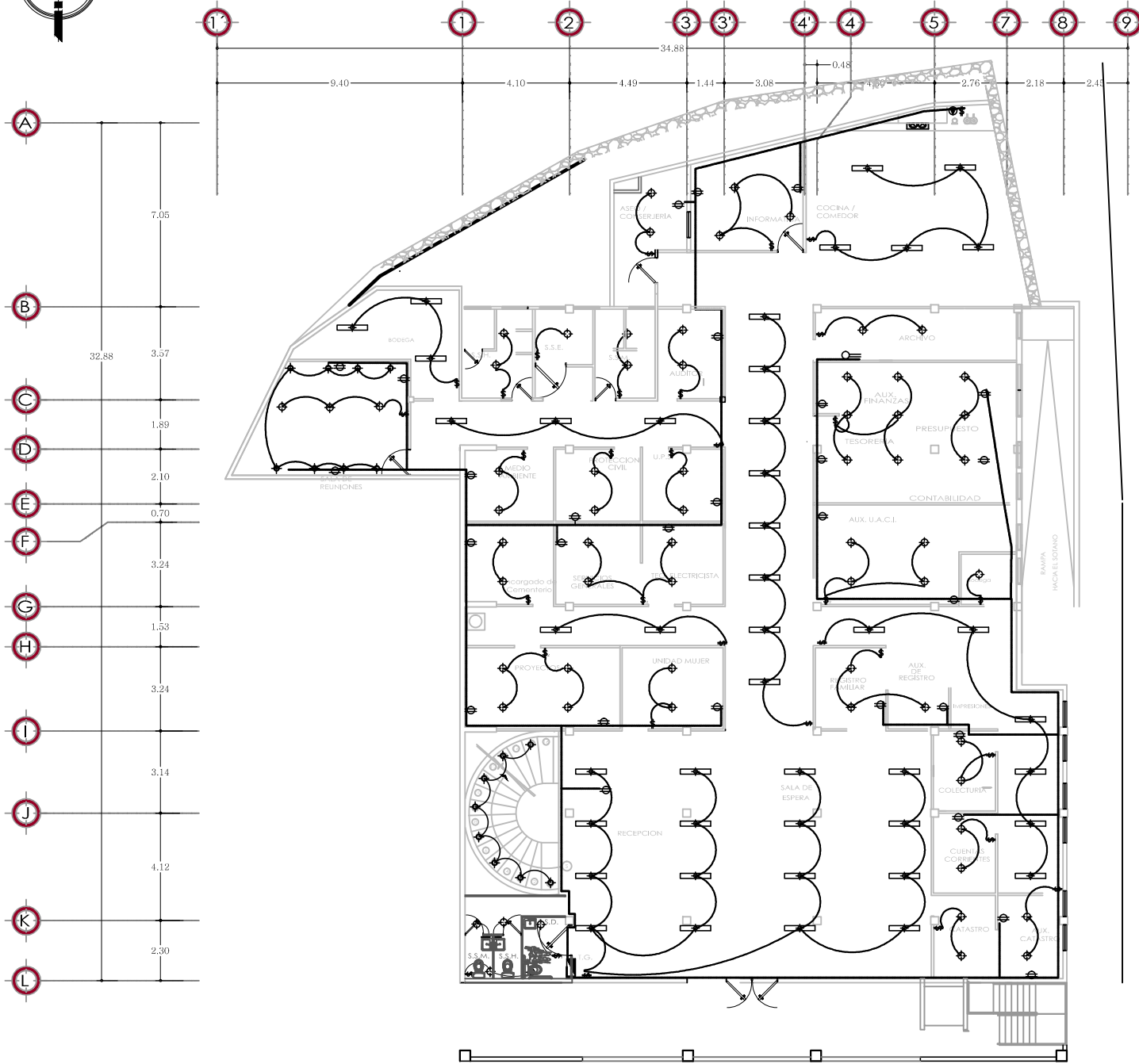
PLANTA DE INSTALACION ELECTRICA PRIMER NIVEL Esc:1:175
