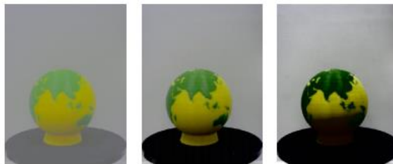
Ilustración 84 Ajuste de contraste para el escaneo de un objeto: sin ajuste y con ajuste. Fuente: Horus, Guía para el escaneo
