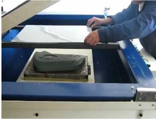
Ilustración 9 Termo formado industrial de plástico
