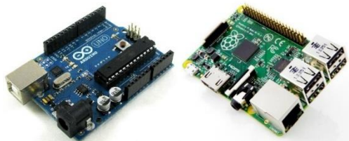
Ilustración 1 Diferentes tipos de placas electrónicas. De derecha a izquierda: Arduino y Raspberry Pi. Fuente: Robotshop.com y cbstatic.com
