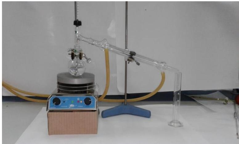
**Figura N° 19** Aparato de destilación
