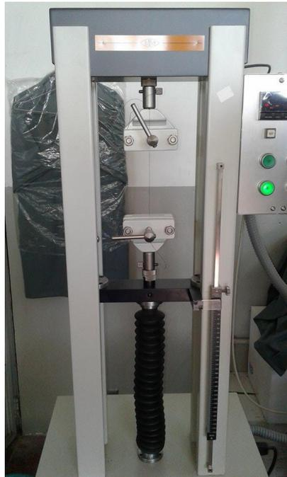
**Figura N° 17** Resistencia a la tensión de las suturas de Nylon, Seda y Poliéster
