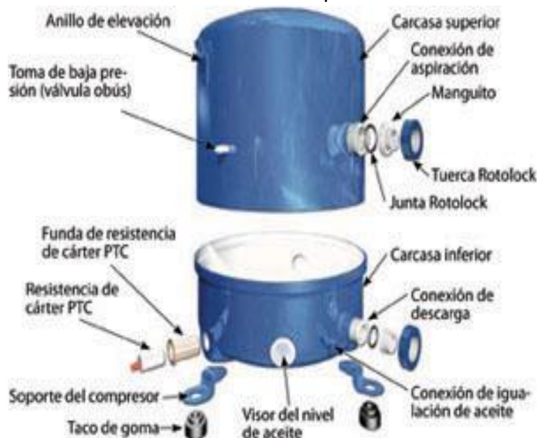
Figura 7. Carcasa de un compresor hermético.
