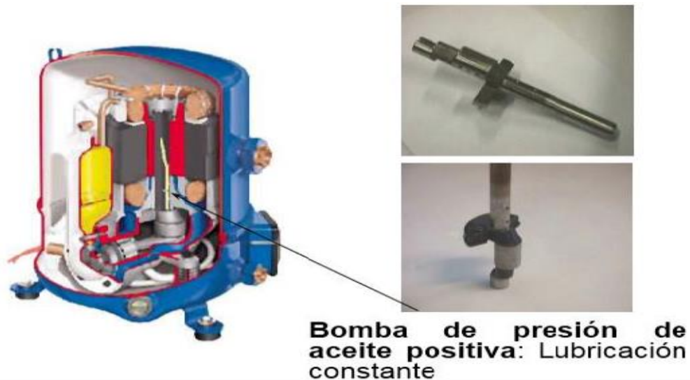
Figura 45. Bomba de aceite en compresores herméticos
