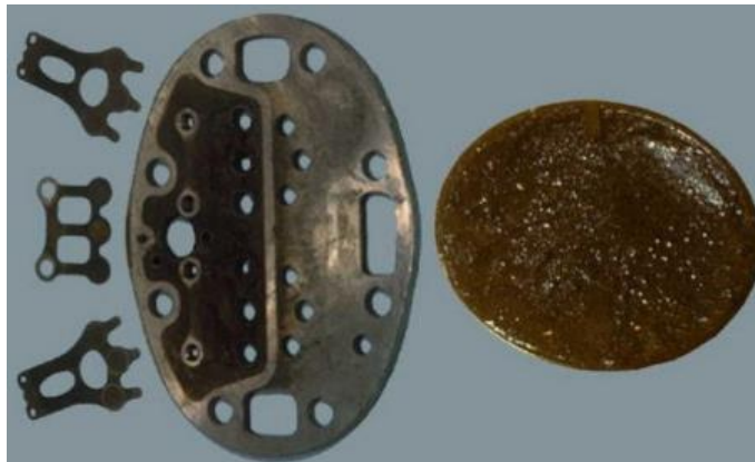
Figura 56. Efecto de alta temperatura.
