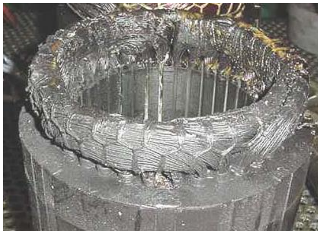
Figura 58. Embobinado quemado completamente
