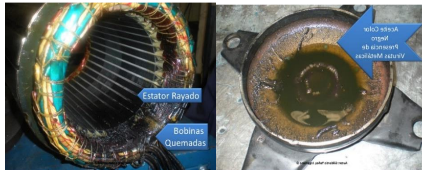
Figura 52. Fallas por quema de aceite
