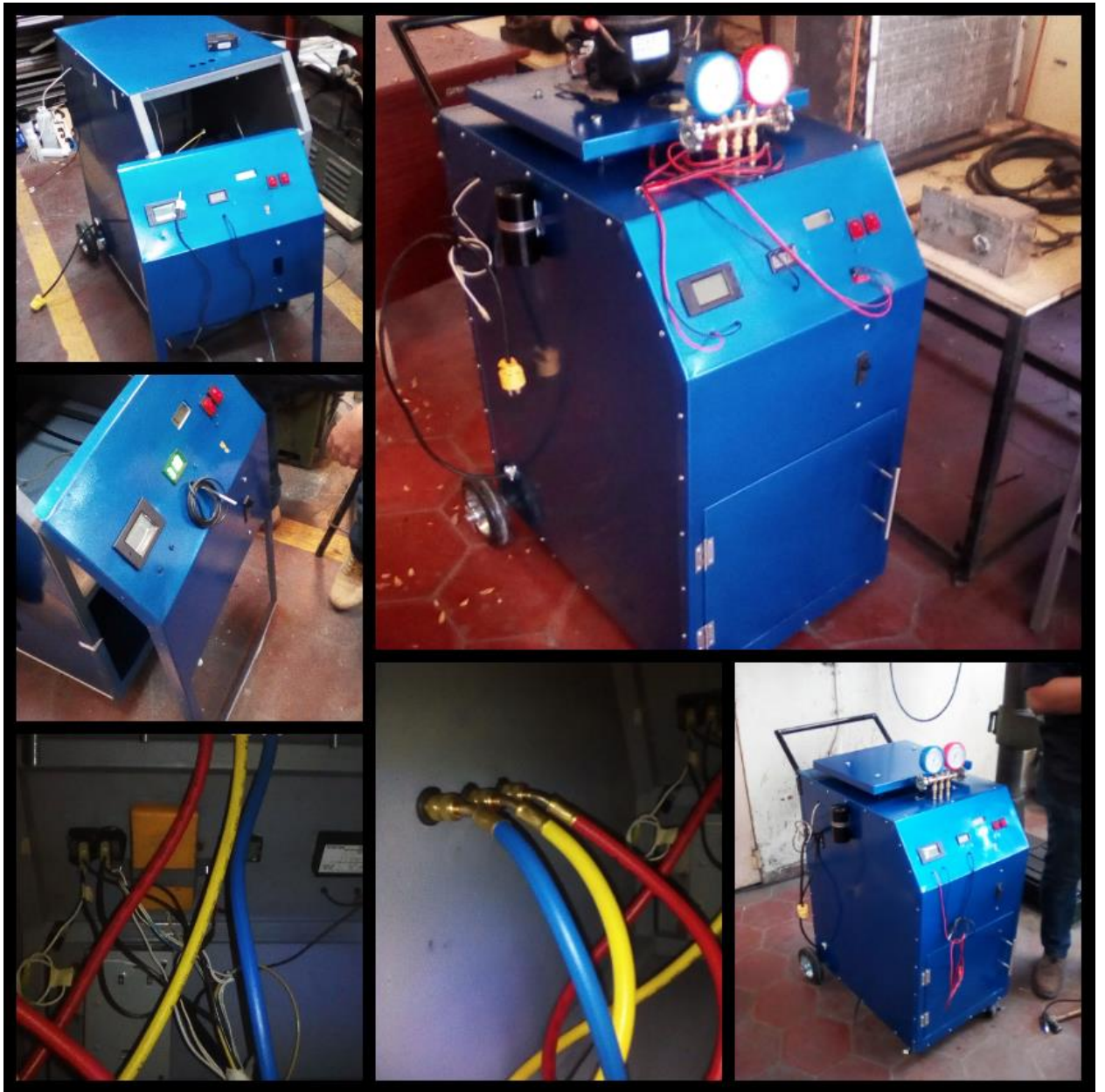
Figura 85. Montaje de accesorios y equipos de medición.
