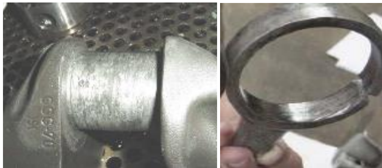
Figura 48. Fallas por mala lubricación.
