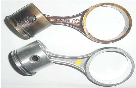
Figura 49. Comparación de pistón con pérdida de aceite.
