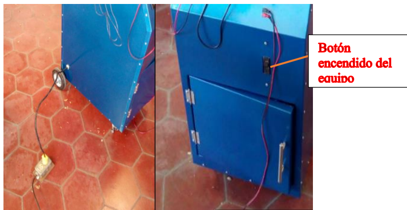
Figura 1. 1 alimentación monofásica, botón de encendido del equipo.
