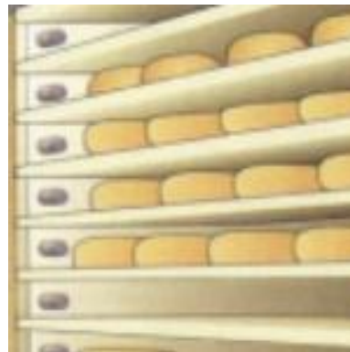
Figura 3.20: Almacén de quesos. El aire humidificado se impulsa a través de boquillas de plástico dispuestas en cada nivel de queso
