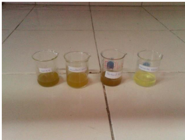
Figura N°13 Muestras de cemento tratadas con HCl (1:1)
