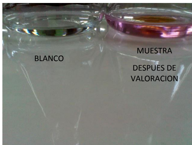
Figura N° 16 Demostración de viraje de color al realizar una valoración Permanganométrica
