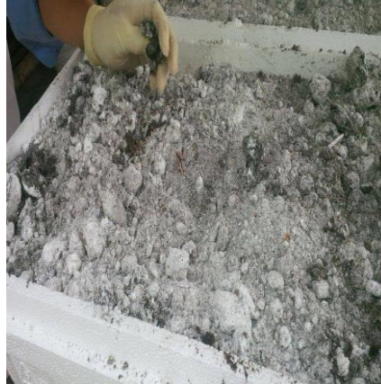
Figura 8. Aplicación de una dosis de cal en uno de los tratamientos.
