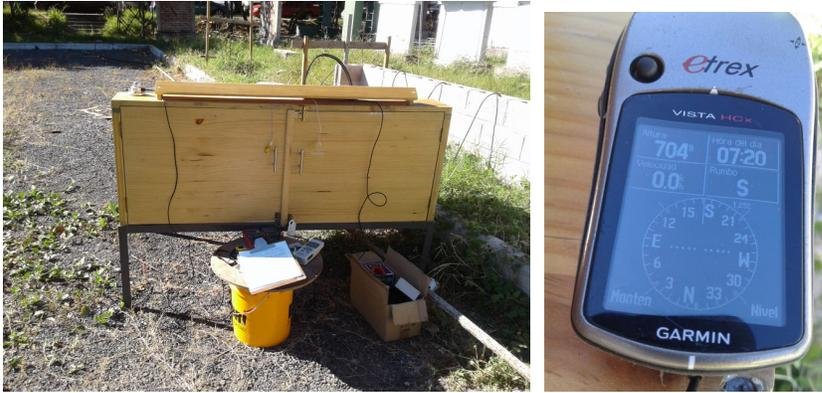
Figura 13.5.5: Preparación horno deshidratador con orientación sur y equipamiento para medir temperaturas, Irradiancias, Humedad y Velocidad de viento, ensayo realizado en Universidad Nacional el día 18de noviembre de 2016.
