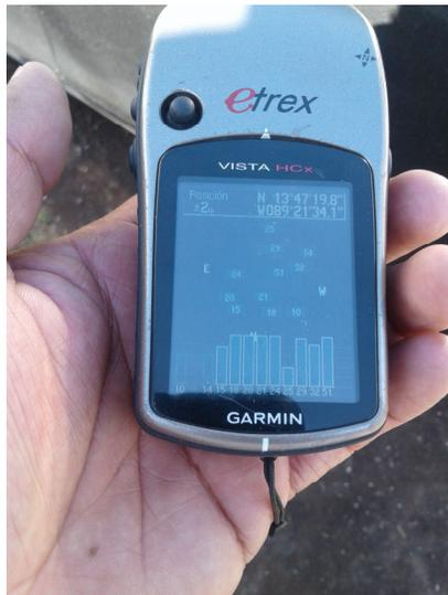
Figura 13.6.5: GPS para toma de las coordenadas, altura y presión atmosférica en el lugar de ensayo.
