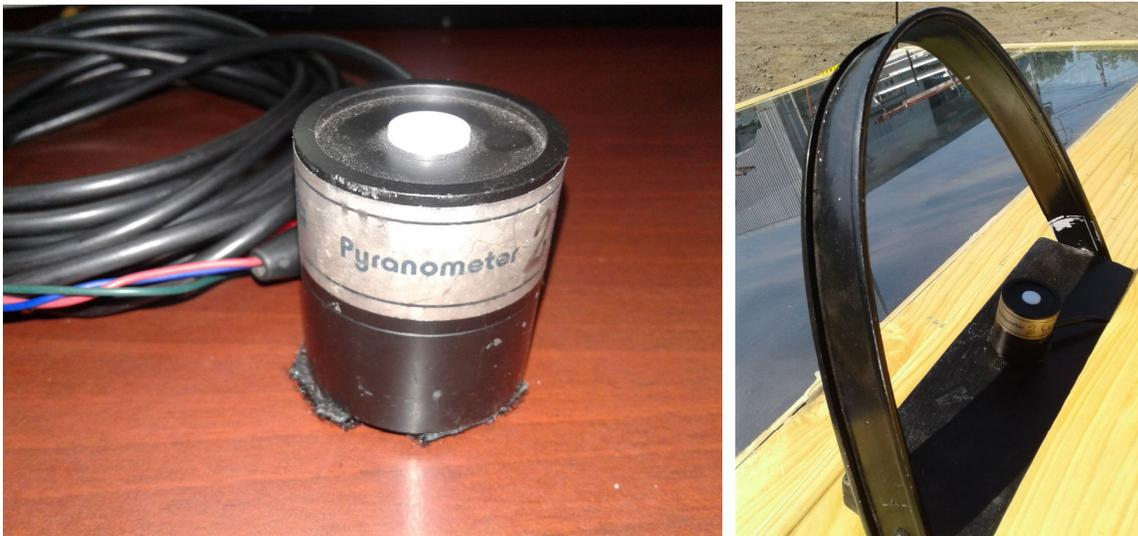
Figura 13.6.3. Pyranometer para medición de irradiancia solar difusa en conjunto del arco generador de sombra.
