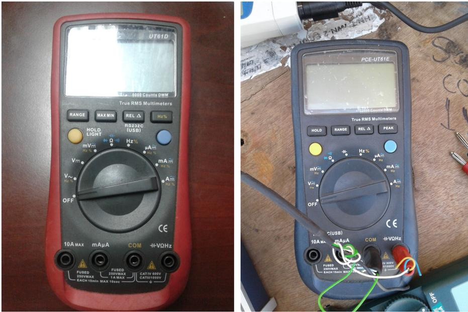
Figura 13.6.0: Amperímetros para la tomo de lecturas de la Irradiancia solar en mV.
