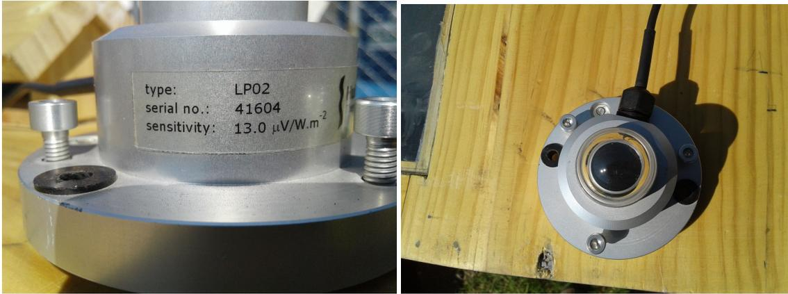
Figura 13.6.2: Pyranometer para medición de irradiancia solar global.
