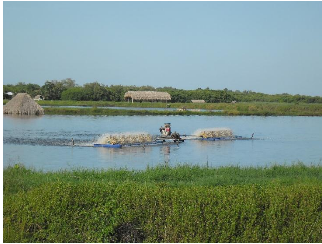
Figura A23. Equipo de Aireadores a gasolina para mantener altas densidades de siembra con aumento del oxígeno disuelto del agua presente en una de las granjas camaroneras.
