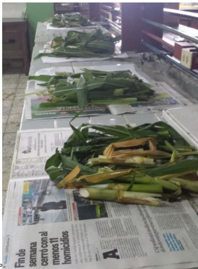
Figura 3.7. Reducción de tamaño de muestras para pruebas físicas de Zacate King Grass en laboratorio, a menos de 10 cm
