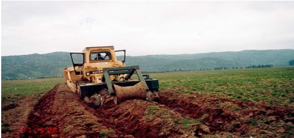
Figura 1.3. Preparación del terreno: Subsulado y rotulación del suelo http://www.sugarcane crops.com
