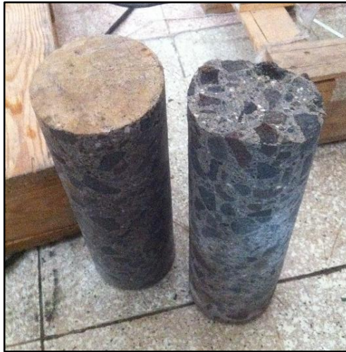
Figura IV-18: Núcleos extraídos de losa de fundación del edificio de la facultad de medicina previos a ser ensayados a compresión.
