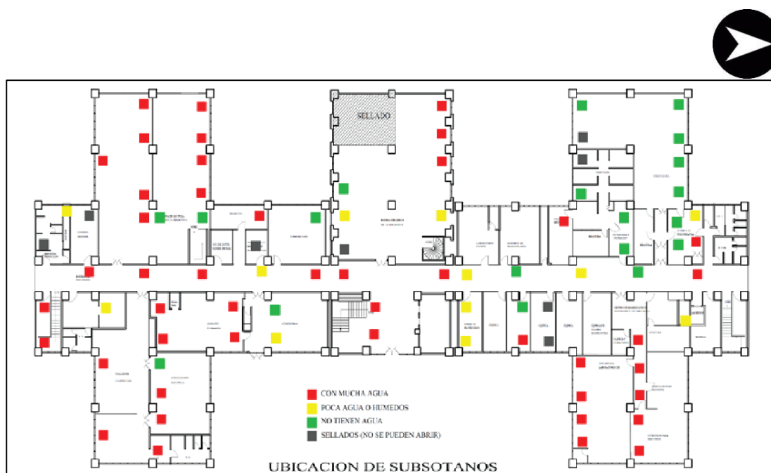
Figura IV-7: Ubicación de sub sótanos en toda el área de construcción de los tres edificios.
