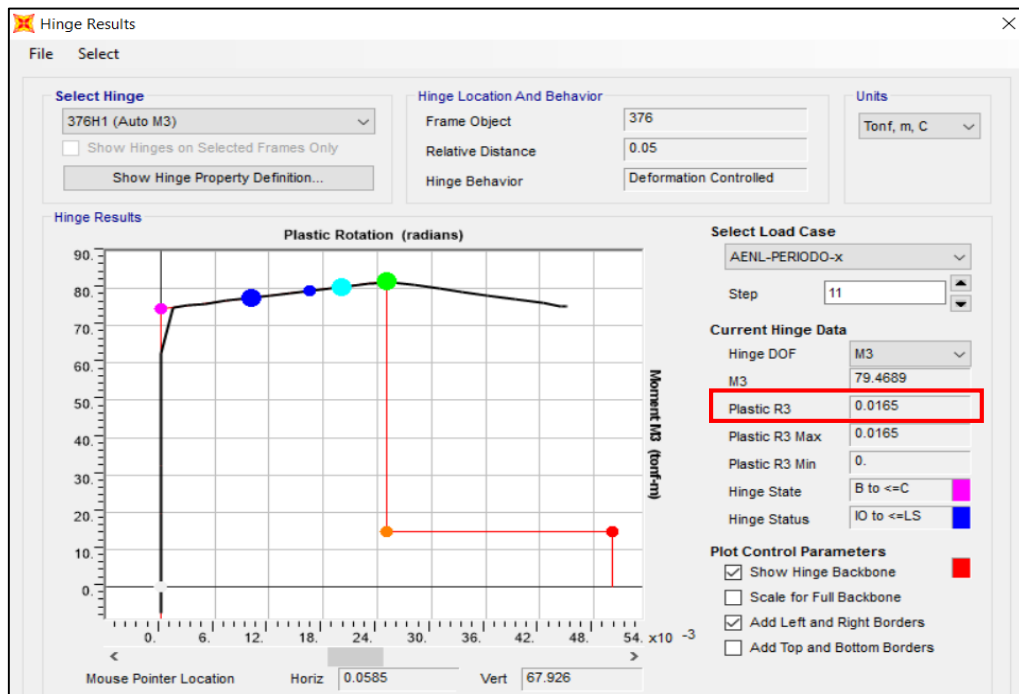
Figura V-23: Comportamiento presentado por una rotula plástica en el punto de desempeño. (Correspondiente a una viga de planta baja)
