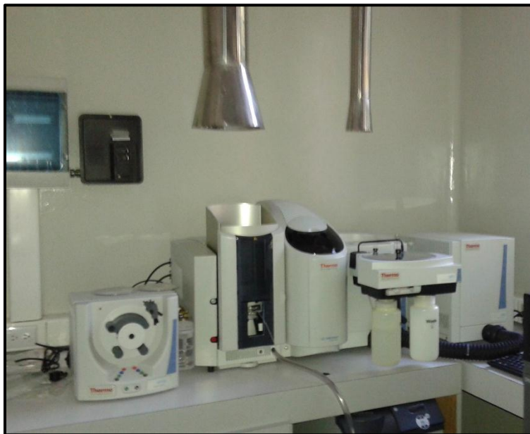
Figura 3.9 Equipo de espectrometría de absorción atómica con horno de grafito
