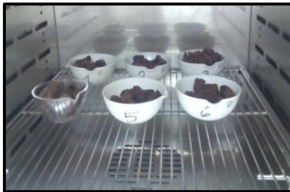
Figura 3.4 Secado de muestras en estufa a 70° C por 24 horas.
