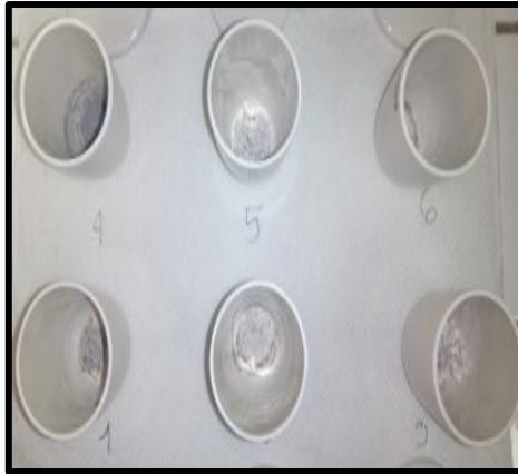
Figura 3.6 Ceniza obtenida del proceso de calcinación de las muestras de chocolate de mesa
