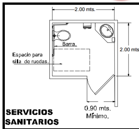
F-2.16. Accesibilidad de baños, detalles. Fuente: http://www.bcn.cl/leyfacil/conozca-sus-derechos/recurso/derechos-de-las-personas-con-discapacidad
