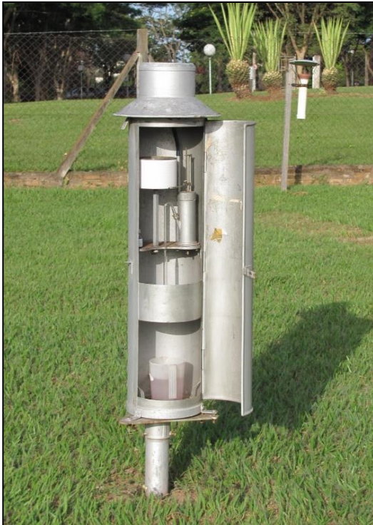
Figura 3. 21 Ejemplos de un Pluviógrafo (Figura de la izquierda) y un Pluviómetro (Figura de la derecha)
