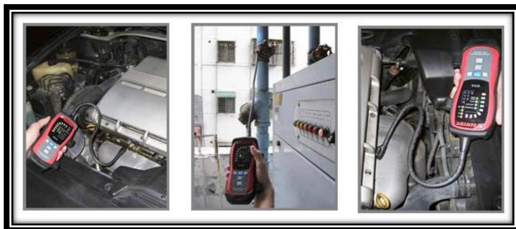
Figura 3-4: Detección de fugas de refrigerantes con detector infrarrojo.
