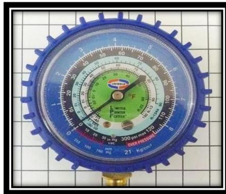
Figura 6-9: Manómetro baja presión Marca UNIWELD.
