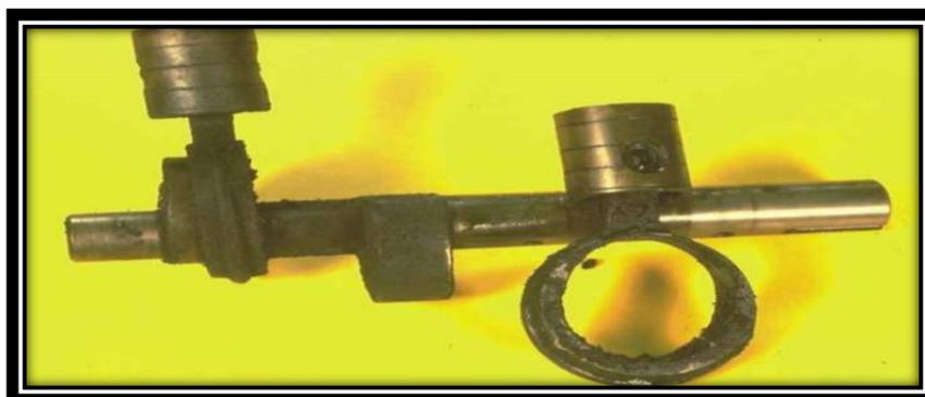
Figura 3-1: Corrosión y lodos en elementos del compresor.
