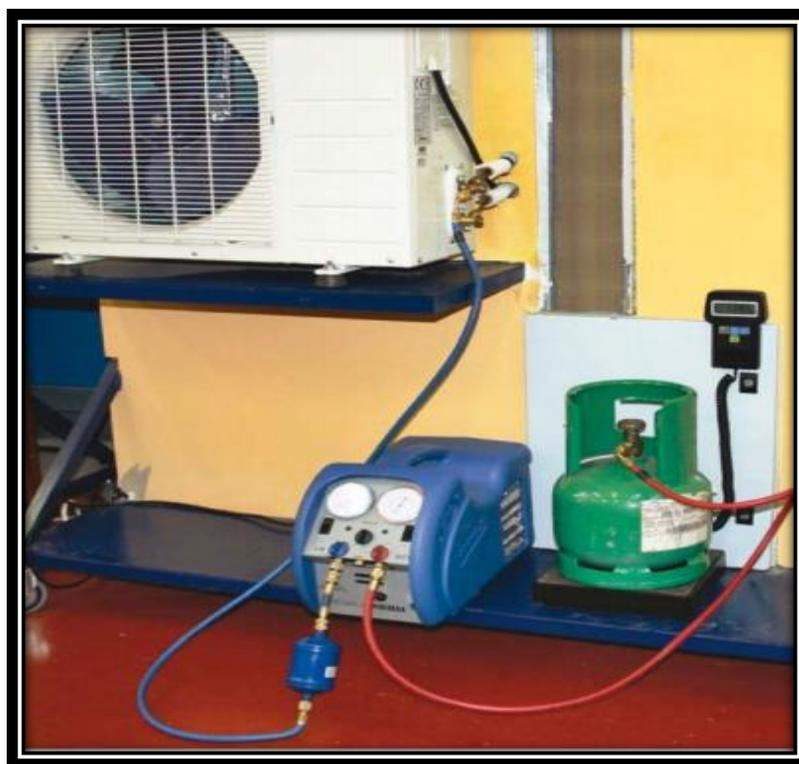
Figura 4-6: Ejemplo de recuperación en fase de vapor.
