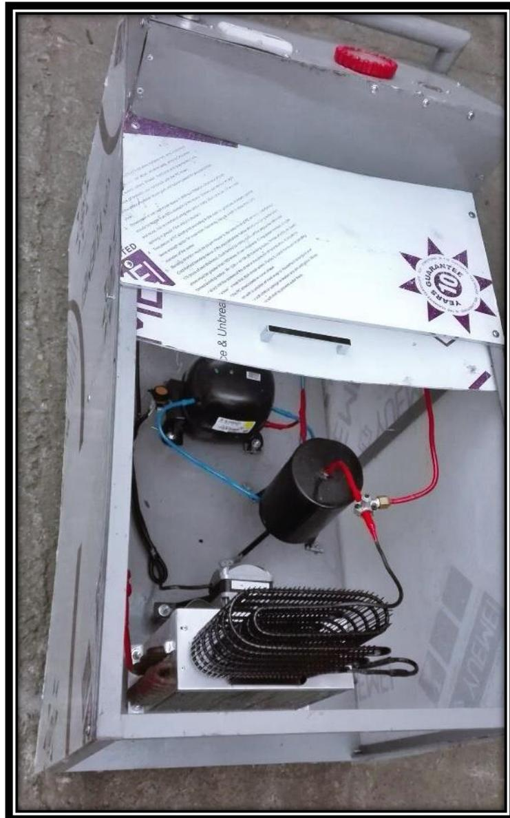
Figura 6-22: Recuperador de refrigerante visto desde la parte superior.
