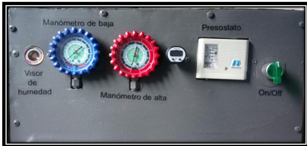
Figura 7-1: Tablero principal de medición y control.
