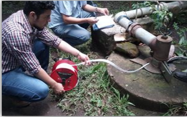
Figura 4.2 Medición de niveles de pozos
