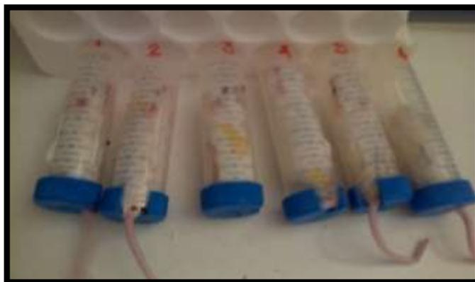
**Figura 4:** Inmovilizadores de ratones, fabricados con tubos cónicos de policarbonato de la marca Becton Dickinson Falcon de 50 ml de capacidad (30x115mm).
