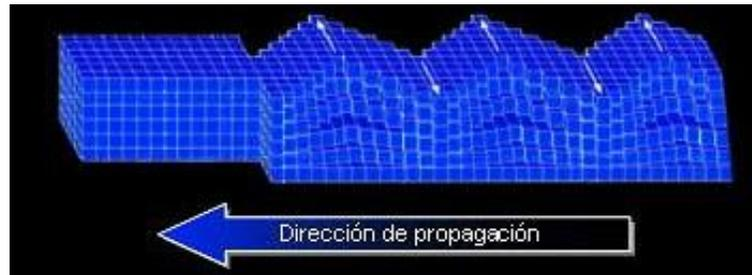
Figura 2.7: Movimiento de las Ondas L. Fuente: Laboratorio de Ingeniería Sísmica, Universidad de Costa Rica, Tipos de ondas sísmicas. URL: <http://www.lis.ucr.ac.cr/index.php?Id=7>
