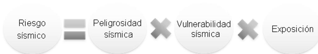
Figura 2.8: Relación entre riesgo sísmico, peligrosidad sísmica, vulnerabilidad sísmica y exposición.
